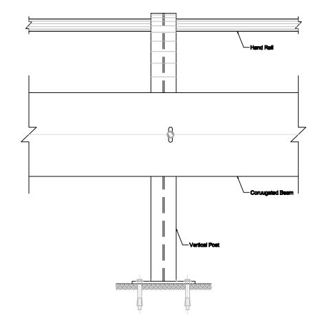
FRONT SIDE ELEVATION SECTION A - A
