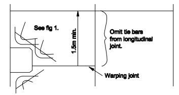
FIG. 3 EXTRA JOINT AT GULLY POSITION
